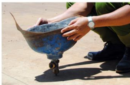
Ngày 19/5/2014, tại khu nhà xưởng sản xuất khí oxy của Công ty TNHH TM và DV Viên Nguyên (lô C2, Khu công nghiệp Tân An, TP. Buôn Ma Thuột, Đắk Lắk) đã xảy ra một vụ nổ chai khí oxy làm 3 người thương vong. Nguyên nhân do sử dụng chai hàn cổ.
