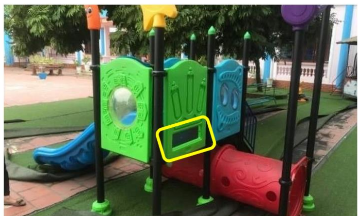
Khi cháu T. chui vào đường ống hình vuông thì bị tuột phần chân và thân người qua ô thoáng hình chữ nhật, còn đầu thì bị mắc lại trong ống. Do chân cháu T. không chạm đất nên cháu bị treo lơ lửng và tử vong (ngày 28/11/2019)
