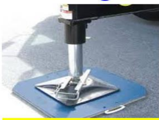
Outrigger đặt trên cribbing khô cách điện, nền đất khô
