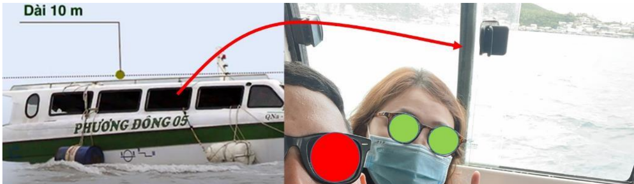
Cửa sổ được thiết kế 02 cánh trượt, khi mở một cánh, một người bình thường (không mặc áo phao) khó có thể chui ra lọt
