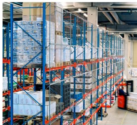
B – Lắp lưới thép sau lưng kệ để ngăn chặn hàng rơi
